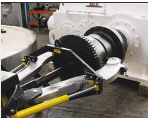
◀ Съемник EPH-1002E легко удаляет этот шкив с вала.
